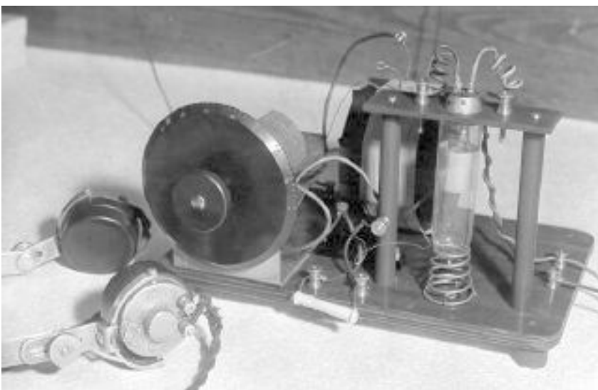
Рис.10. Общий вид радиоприемника на двухэлектродной лампе конструкции А.Флеминга. 1905 г.
