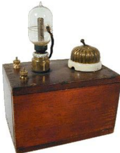
Рис. 15. Общий вид радиоприемника на двухэлектродной лампе конструкции А. Флеминга. 1910 г.
