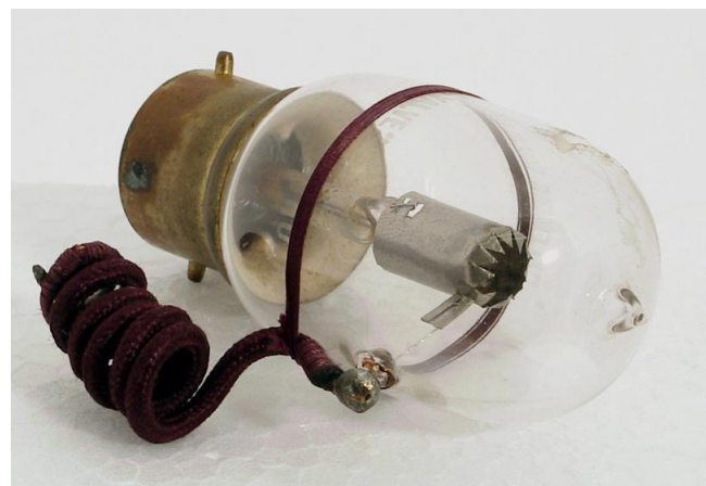
Рис. 16. Общий вид двухэлектродной лампы конструкции А.Флеминга. 1910 г.
