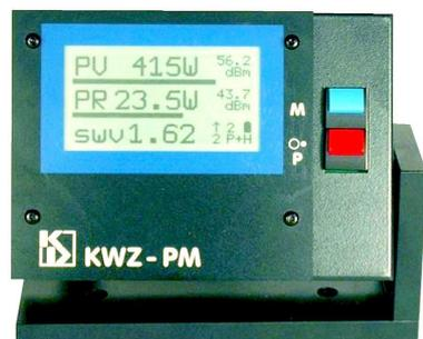
Прибор индицирует на ЖК-дисплее падающую и отраженную мощность в ваттах и дБм, а также КСВ. Измеренные величины могут отображаться как в цифровом виде, так и в виде аналоговой гистограммы, что удобно при настройке радиопередающих устройств и антенн. KWZ-PM функционально состоит из направленного ответвителя и блока контроллера и индикации, а конструктивно выпускается в одном корпусе (KWZ-PM2) или с выносным блоком направ-
