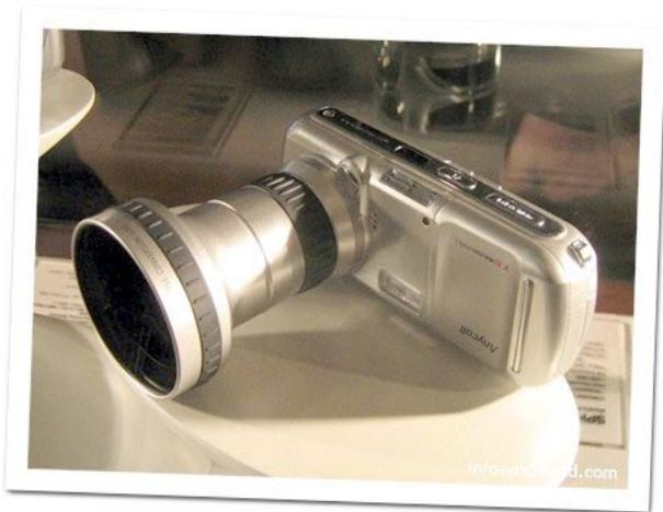
имеет 3-кратный оптический зум (цифровой x20) и насадки для широкоугольной и телескопической съемки (см. фото). Для съемки в темноте предусмотрена фотовспышка. Да и собственно телефонные функции SCH-V770 недурственны - **имеются и GPRS класса 10, и email-клиент, и встроенный модем, и Bluetooth с IrDA**. Размеры 127x52x27 мм, вес 180 г (<http://www.infosyncworld.com/news/n/5879.html>).
