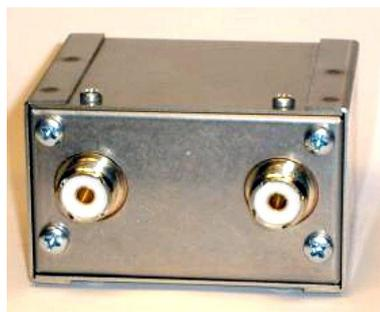
ного ответвителя (KWZ-PM1). Прибор оснащен специальным оптронным датчиком превышения установленного уровня КСВ, сигнал с которого может использоваться, например, для отключения усилителя мощности радиостанции. Предусмотрена возможность управления с ПК через порт RS-232.
