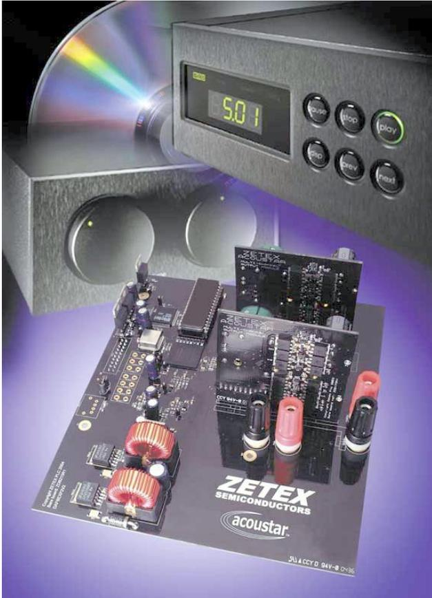
цифровой ОС, компенсирующей нелинейности мощных МОП-ключей и катушек индуктивности выходных LC-фильтров, а также устраняющей негативное влияние пульсаций и «просадок» питающего напряжения. «Бесплатные» бонусы такой технологии - быстродействующая защита от перегрузок, автодиагностика усилителя и др. Технические характеристики прототипа: Кг < 0,005%, коэффициент демпфирования > 250.
