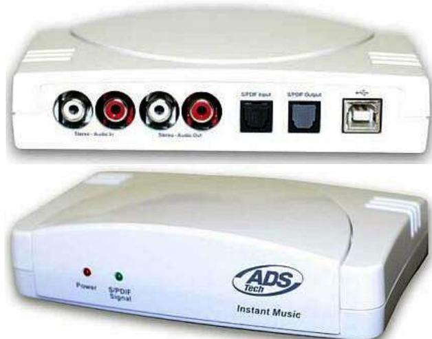
**Instant Music** (<http://www.adstech.com>). Это устройство имеет (<http://www.thg.ru/video/20050516/>) 2 аналоговых входа/выхода на стандартные «тюльпаны» RCA, оптические вход/выход S/PDIF, порт USB 2.0 и обеспечивает неравномерность АЧХ +0,23, -0,12 дБ (20 Гц ... 20 кГц), уровень шума -63,4 дБА, Кг < 0,12%. Это по сути внешняя «звуковая карта», соединяемая с ПК посредством USB порта, в комплект поставки которой входят программы *Nero Audio Suite*, *Nero SoundTrax* и *Nero*
