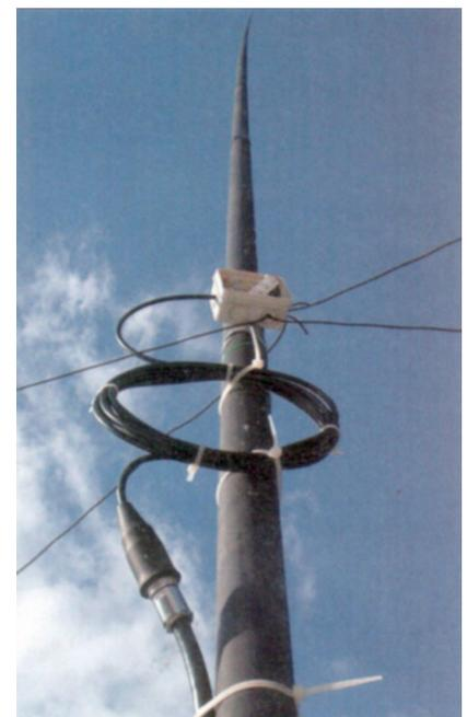
щего устройства, но ВЧ дроссель поверхностных волн надо использовать, выполнив его из 6-8 витков кабеля питания, свитого в бухту диаметром около 10 см (рис.54). Угол между радиальными парами противовесов составил 20-30 градусов, но мог быть и 90°. Настройка антенны заключается в подборе длины противовесов по наименьшему КСВ. При этом нужно учитывать, что она имеет острый резонанс на каждом диапазоне, а длины противовесов могут отличаться от указанных на рис.52 в зависимости от
