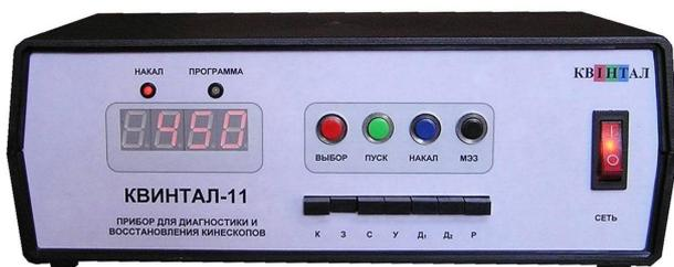
ли прибор оснащен электронным вольтметром на 3,5 разряда, что позволяет измерять ток эмиссии катодов от 0 до 1999 мкА без дополнительных коммутаций. Высокая точность измерения, наглядность и надежность - безусловные преимущества этого прибора. К другим важным преимуществам необходимо отнести усовершенствованную методику диагностики
