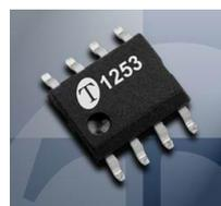
Коэффициент передачи  $\pm 0,05$  дБ ( $f_v = 22$  МГц), коэффициент гармоник 0,0005%, уровень собственных шумов -106 дБн, напряжение питания  $\pm 3...18$  В, максимальное входное напряжение  $\pm 13$  В. Немного упрощенная серия ИМС **125x** имеет аналогичное назначение, но совместима по выводам с TI INA134 и Analog Devices SSM2141 и в мелкооптовых поставках стоит всего полдоллара (<http://www.thatcorp.com/1250desc.html>).
