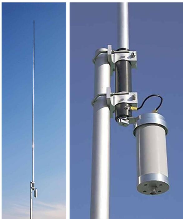
тором в выдвинутом положении, а при стационарной эксплуатации - дополнительными винтовыми фиксаторами. Входное сопротивление 50 Ом. Максимальная подводимая ВЧ мощность 150 Вт. Вес 2 кг. Благодаря своей легкости, ветроустойчивости и простоте сборки может рекомендоваться для полевых условий эксплуатации.
