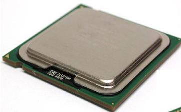
QDR) и кэшем L2 на 1 МБ. Поскольку множитель частоты Pentium D 805 фиксирован и равен 20, есть
