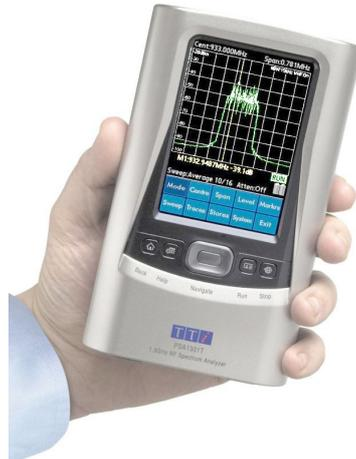
Этот малогабаритный и недорогой прибор, который легко умещается на ладони, обладает уникальными техническими и эксплуатационными характеристиками благодаря применению достаточно мощного процессора. По сути, это два прибора: спектроанализатор и ручной ПК типа Palm TX. PSA1301T имеет частотный диапазон от 150 кГц до 1300 МГц, полосы разрешения 280 кГц или 15 кГц, уровень шума -93 дБм (считая от
