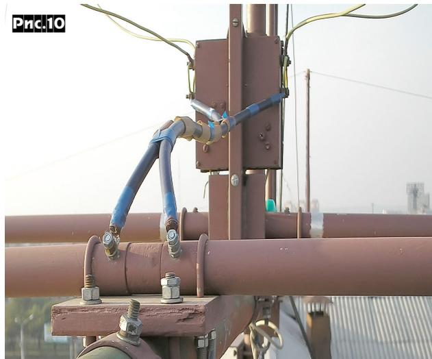
Активные элементы на узкополосные **WARC** диапазоны выполнены из гибкого многожильного провода в изоляции **ПВ3** сечением 2,5 мм<sup>2</sup>. Приведенные на **рис.8** реальные размеры составных частей **A12** и **A17**, полученные при настройке, несколько отличаются от расчетных (наличие изоляции на проводах, непрямолинейная форма начальных участков).
