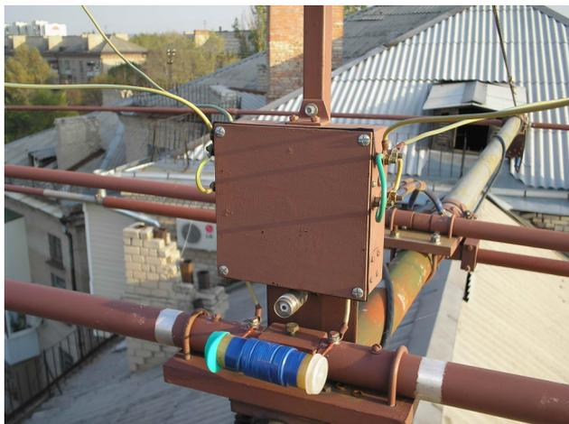
Lvx=7 мкГн (секция W102). В результате рабочая полоса (по KCB=2) увеличилась на ~40%. На диапазоне 20 м действие этой катушки значительно слабее и проявляется в небольшом улучшении согласования на крайних частотах диапазона, на 17 м действие аналогичное и ещё более слабое, на остальных диапазонах практически без изменений. Данные Lvx: каркас стеклотекстолитовый Ø27,5 мм, провод МГТФ 0,75 мм², число витков 20, гидроизоляция изолянтной NOVA ROLL.
