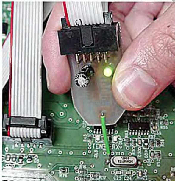
питание осуществляется через разъем K1 от устройства, в котором установлен микроконтроллер. Процедура восстановления состоит в касании иглой пробника на контакт входа XTAL1 микроконтроллера, что можно осуществлять и на кварц без выпаивания последнего (рис.22). При этом ваш программатор сразу распознает AVR и позволит осуществить его прошивку («Elektor» №7-8/2011, с.69, 70).
