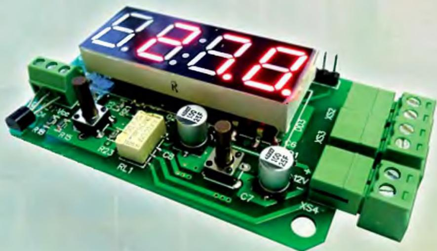
Простой и надежный одноканальный цифровой термостат с возможностью измерения и контроля температуры в диапазоне  $-55^{\circ}\text{C}$  до  $+125^{\circ}\text{C}$ . Управление устройства сводится к установке температуры срабатывания и температуры отпускания встроенного реле. Шаг установки гистерезиса составляет  $0,5^{\circ}\text{C}$ . Максимальная мощность коммутации встроенного реле 50 Вт.
