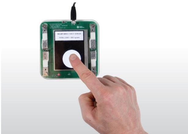
Обычные весы дают информацию лишь в одном измерении, сверху вниз. Оценочный набор MAXREFDES82# обеспечивает измерение как силы тяжести, так и положения центра масс, собирая и обрабатывая информацию с четырех тензометрических датчиков с помощью MAX11254 – 24-битного 6-канального аналого-цифрового преобразователя (АЦП). Эта конструкция, уникальность кото-
