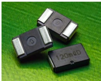
Предназначенные в первую очередь для измерения тока резисторы SLN5 могут с успехом использоваться на рынках транспортной, промышленной, телекоммуникационной и бытовой электроники в таких приложениях, как персональные компьютеры, DC/DC преобразователи, автомобильные модули, устройства управления двигателями и источники питания. Срок поставки SLN5 составляет 12 недель. Образцы доступны по запросу.
