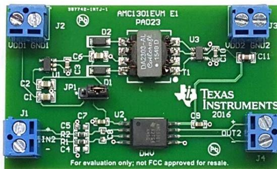
Базовый проект TIDA-00366 для усиленной изоляции 3-фазных инверторов с платой защиты от перегрузки по току и напряжению, а также от перегрева.
