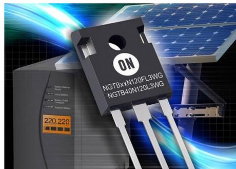
По уровню полных потерь переключения эти 1200-вольтовые устройства могут стать лидерами отрасли. Столь замечательное улучшение характеристик отчасти объясняется очень широким высокоактивированным слоем Field-Stop и оптимизацией параметров встроенного диода.
