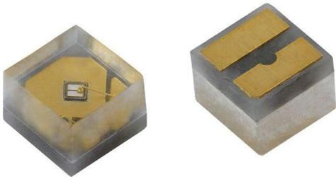
излучения 18 мВт при токе 20 мА и 50 мВт при токе 60 мА в диапазоне длин волн между 362.5 нм и 370 нм. Угол излучения VLMU1610-365-135 равен 135°. Характеристики светодиода делают его идеальным прибором для ультрафиолетового отверждения лака в мани-
