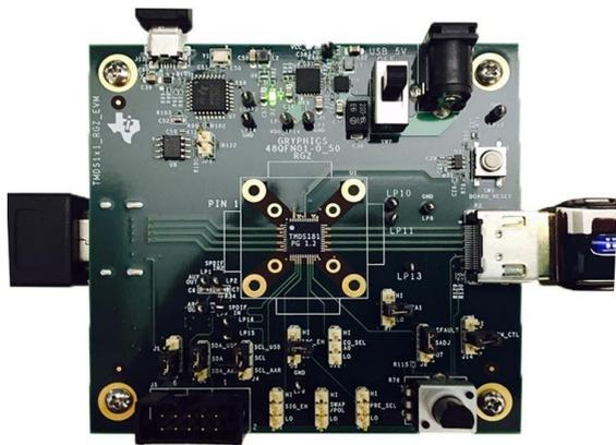
Оценочный модуль TMDS181RGZ EVM ретаймера TMDS181RGZ.
