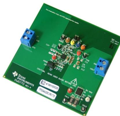
Оценочный модуль синхронного двухфазного преобразователя TPS54A20EVM-770.
