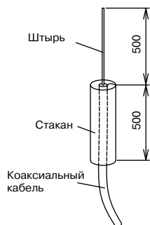
Рис. 30. Конструкция антенны
