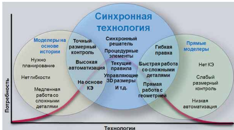
Рис. 1.3.2. Синхронная технология как принцип, объединяющий подход к проектированию на основе истории и системы прямого моделирования
