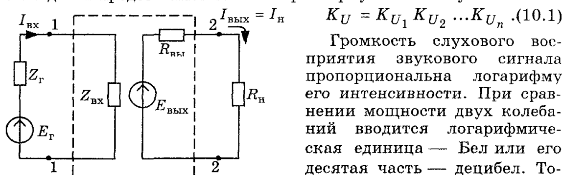
Рис.10.4. Представление усилителя в виде активного четырехполюсника
