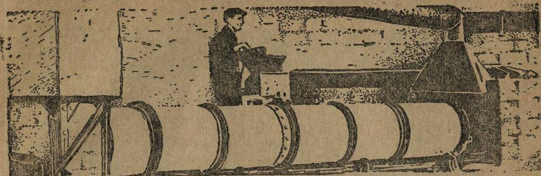
Опытная цилиндрическая вращающаяся печь для восстановительного обжига железных руд на испытательной станции "Механобра". К лабораторному исследованию методов обработки керченских и криворожских руд
